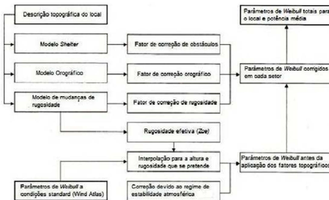
Figura 21 – Parte de Aplicação do *WAsP*
