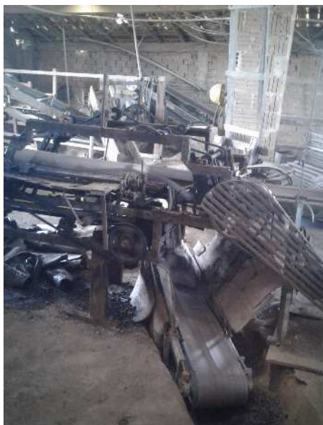
Figura 3.8: Telhas sendo cortadas após saírem da extrusora.
