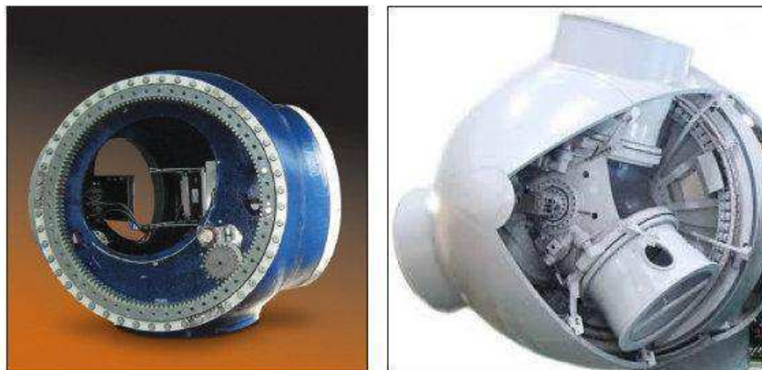
Figura 26. Cubo do rotor e subcomponentes.
