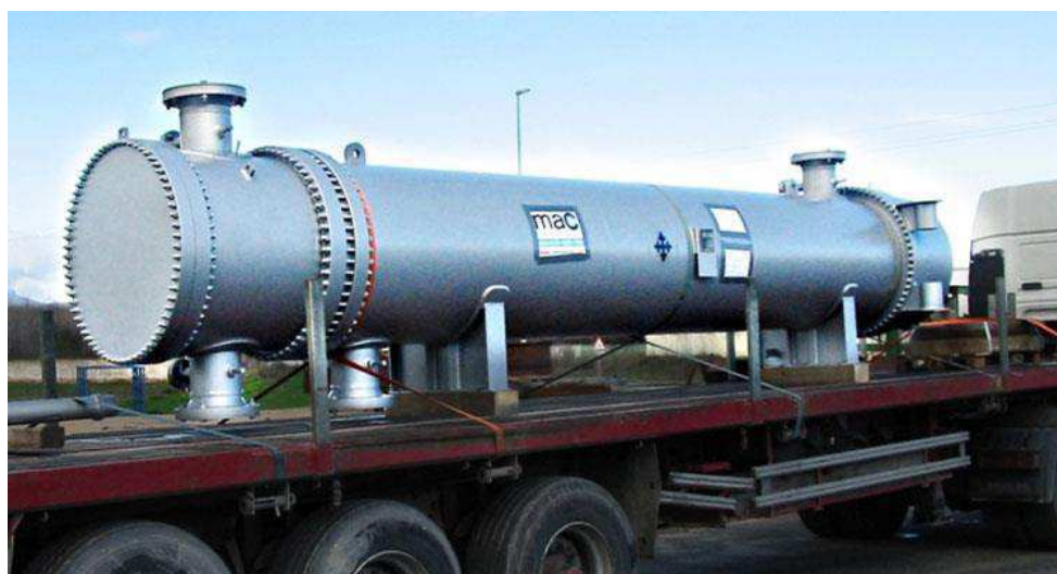
Figura 1. Trocador de calor do tipo casco-tubos de 7,6 m de comprimento e 0,98 m de diâmetro 1 .
