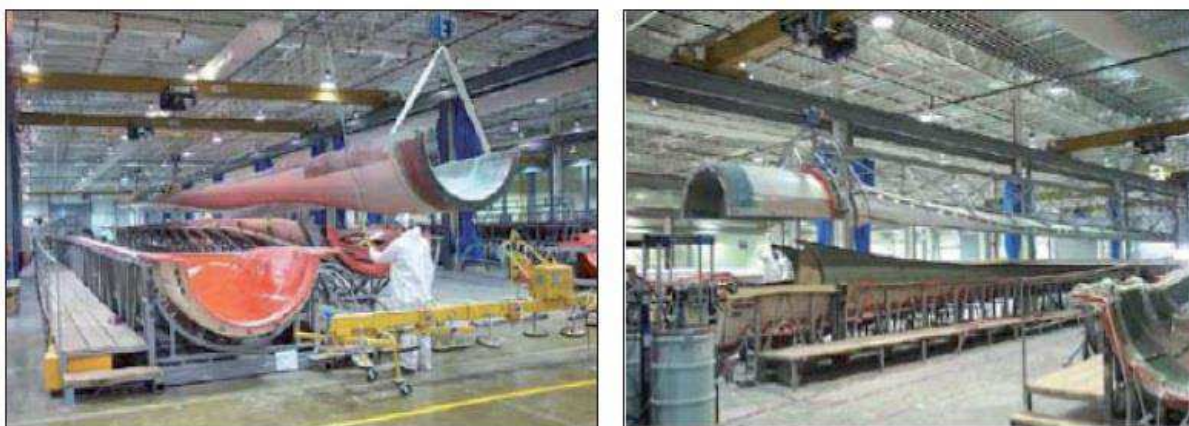
Figura 23 – Processo de fabricação e montagem das pás eólicas.
