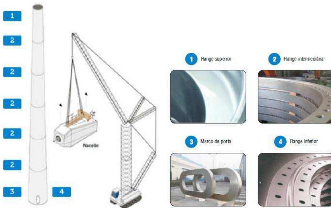
Figura 21 - Componentes forjados - torres de aço cônicas.
