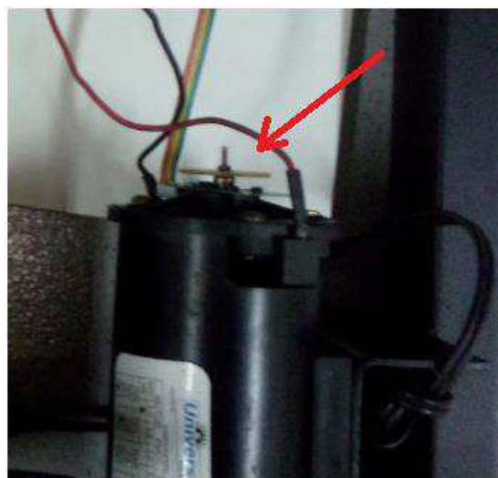
Figura 12: Encoder fixado ao eixo do motor.
