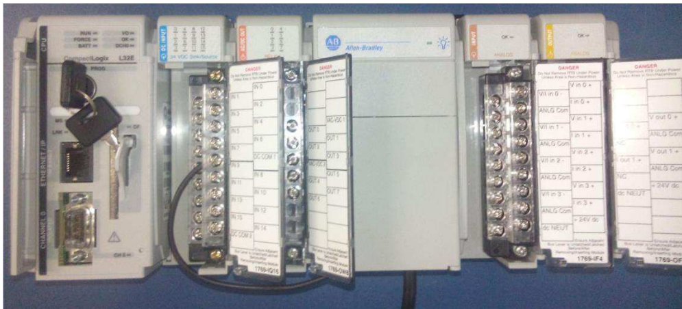
Figura 2: CLP CompactLogix com cartões de entradas e saídas.
