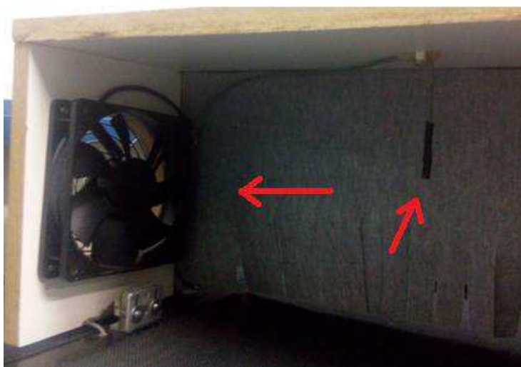
Figura 29: Módulo de Resfriamento, com detalhes a ventoinha e o sensor LM35.
