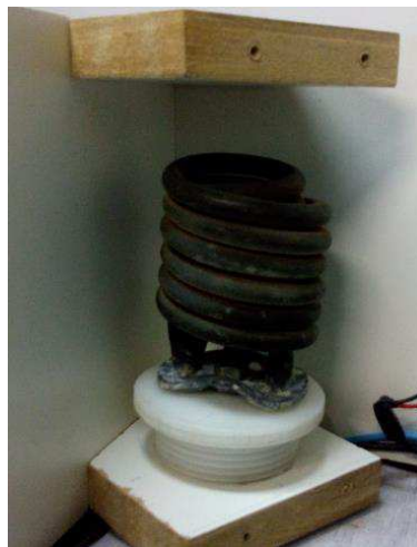
Figura 25: Resistência 1400 W utilizada no módulo de aquecimento.
