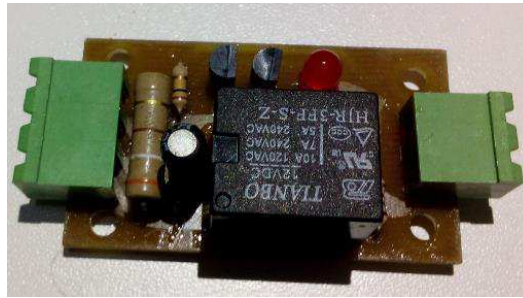
Figura 38: Dispositivo de identificação de CLP desligado.
