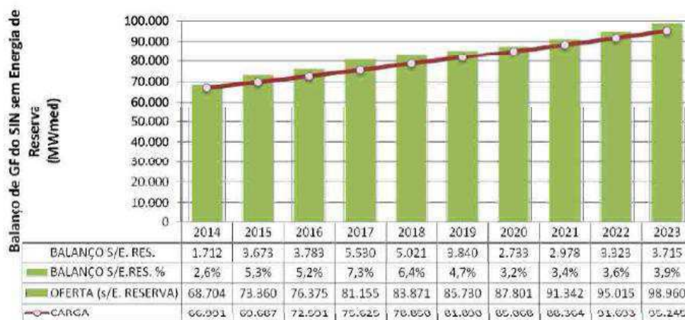
Figura 16. Balanço de garantia física do SIN não considerando a energia de reserva.
