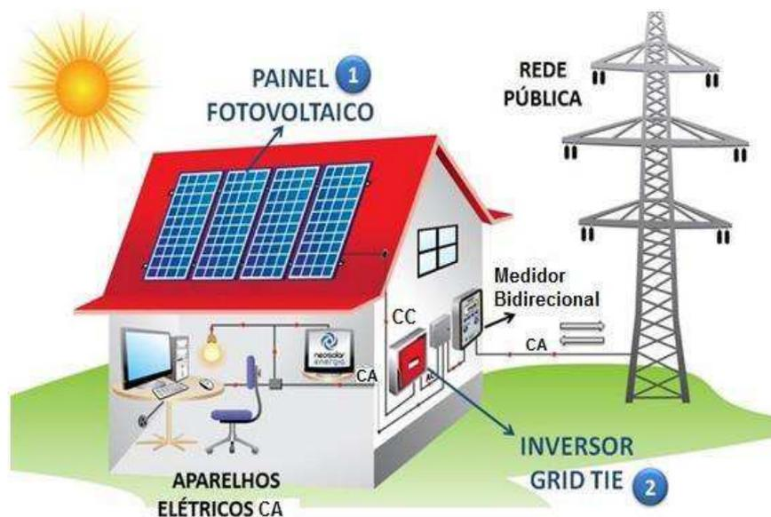
FIGURA 1 SISTEMA FOTOVOLTAICO RESIDENCIAL CONECTADO À REDE ELÉTRICA
