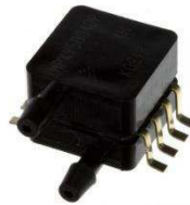
Figura 28. Encapsulamento do sensor MPXV5004DP Fonte: (FREESCALE SEMICONDUCTOR, INC., 2009)
