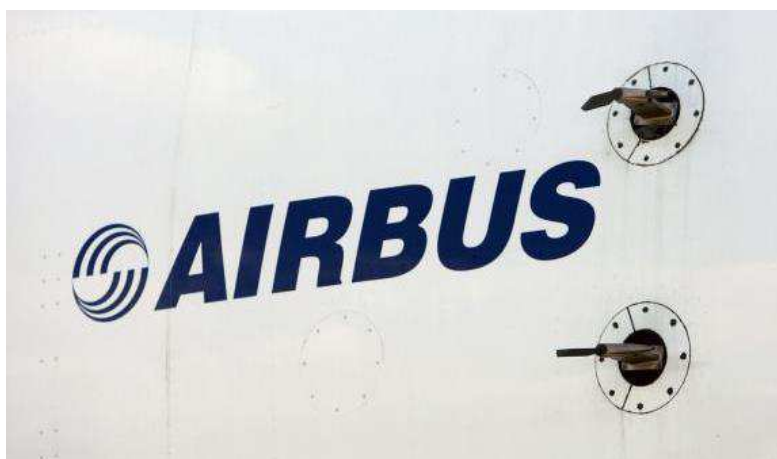
Figura 18. Tubos de Pitot em um avião Fonte: (UNITED PRESS INTERNATIONAL, 2009)
