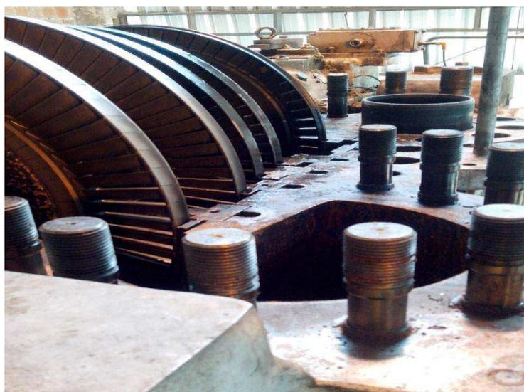
**Figura 4:** Estágios da turbina de contrapressão.
