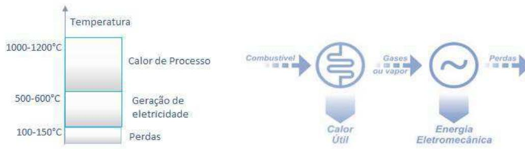
**Figura 3:** Esquema de aproveitamento do calor no modelo bottoming (Carvalho, Nogueira e Teixeira, 2004 – adaptado)
