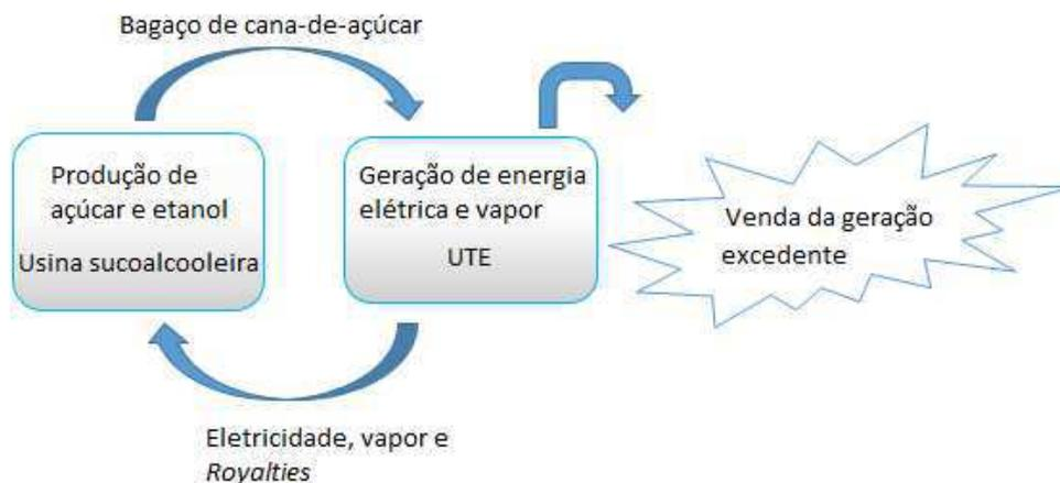
**Figura 13:** Esquema do acordo de cogeração.
