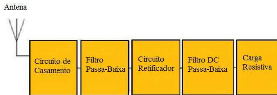
Figura 2 – Diagrama de blocos de uma Rectenna.
