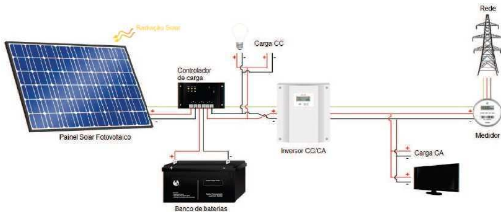
Figura 14–Diagrama esquemático de sistema fotovoltaico conectado à rede elétrica.
