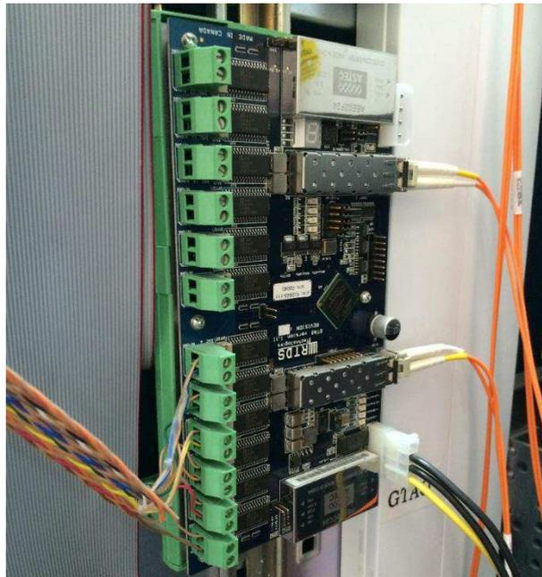
Figura 3.26: Conexão de seis canais do cartão GTA0 para externar os sinais de corrente e tensão oriundos do RTDS™.
