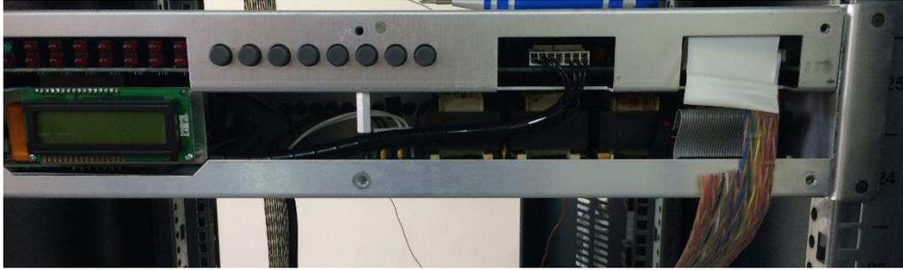
Figura 3.24: Conexão das saídas do RTDS™ ao relé.
