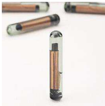
Figura 4. Tag do tipo involucro de vidro.
