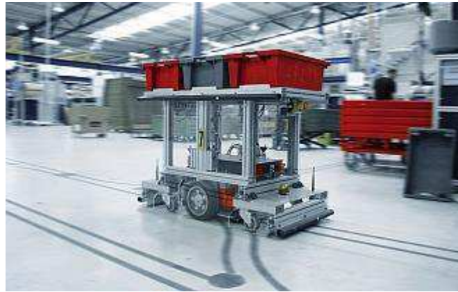
Figura 9. Exemplo de um agv guiado por uma faixa magnética. Fonte: [12].
