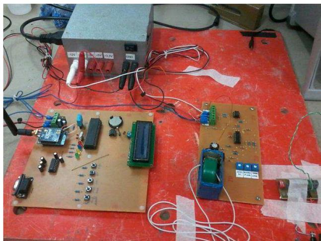
**FIGURA 16(B).** Fotografia do circuito das placas das unidades de entrada, condicionamento e processamento interligadas.
