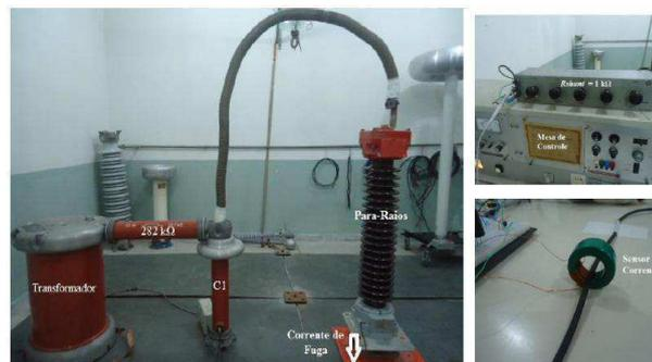
FIGURA 21. Fotografias do arranjo experimental utilizado para a medição de tensão e corrente de fuga no para-raios ZnO.
