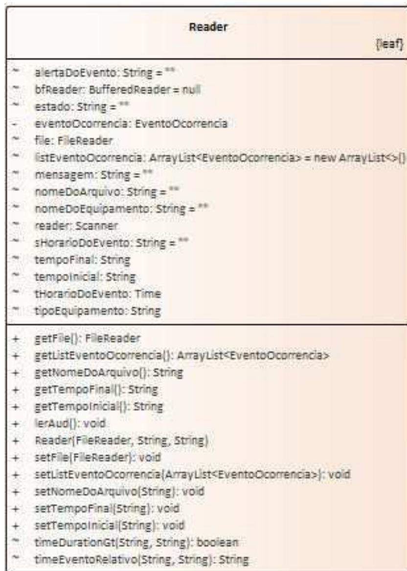
Figura 31: Diagrama de classe do reader (Fonte: o próprio autor).
