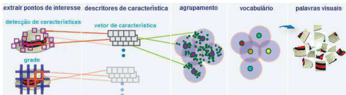
Figura 1. Representação do fluxo do algoritmo de classificação de imagens com pacote de visual words (MATHWORKS)
