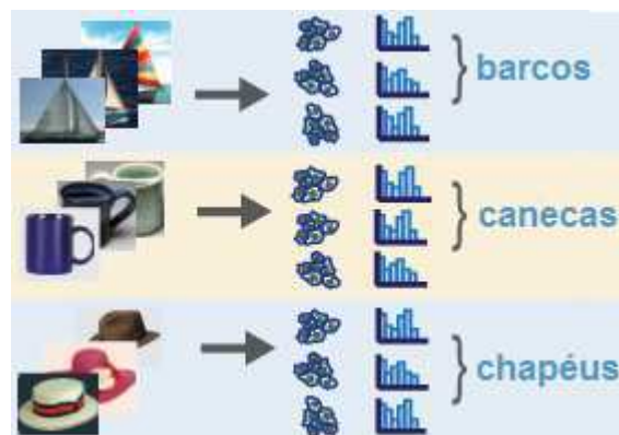
Figura 3. Esquema do agrupamento de histogramas para cada classe do classificador (MATHWORKS)
