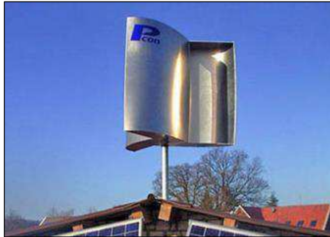
Figura 16 – Turbina de eixo vertical tipo Savonius.
