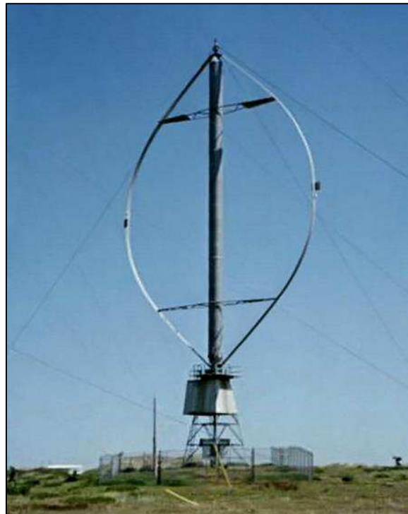
Figura 17 – Turbina de eixo vertical tipo Darrieus.
