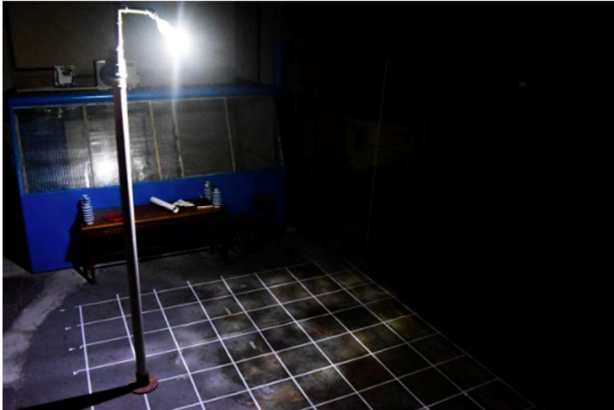
Figura 33: Disposição dos pontos de medição para a curva Isolux
