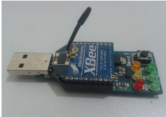
Figura 3.1 - Fotografia do adaptador serial utilizado nos experimentos Fonte: O próprio autor
