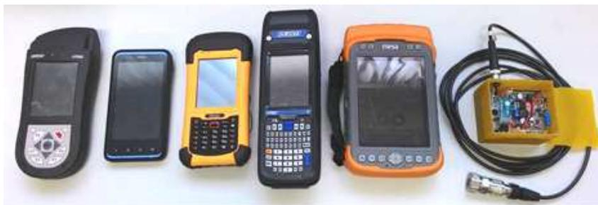
Figura 5 – Plataforma de aquisição de dados (direita) e PDAs utilizados para a distribuição do sistema (LIMA et al., 2016)
