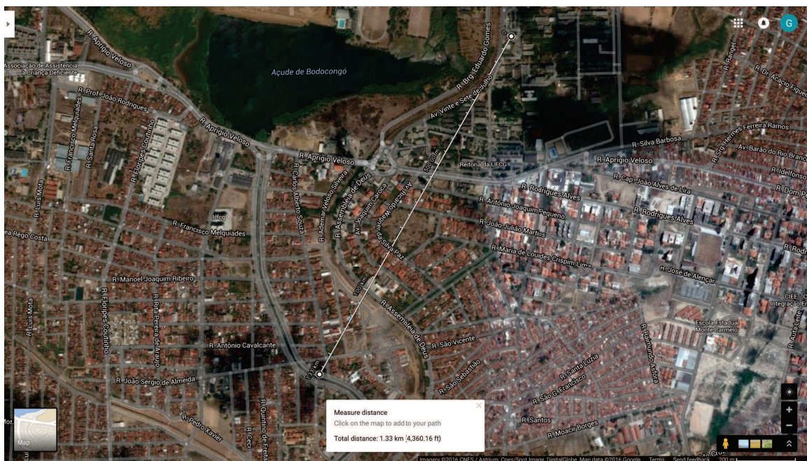
Figura 17 – Distância de transmissor e receptor onde cessou a comunicação do Si4468 durante o quinto teste (GOOGLE MAPS, 2016).
