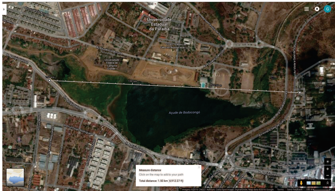
Figura 15 – Distância de transmissor e receptor onde cessou a comunicação do Si4468 durante o quarto teste (GOOGLE MAPS, 2016).
