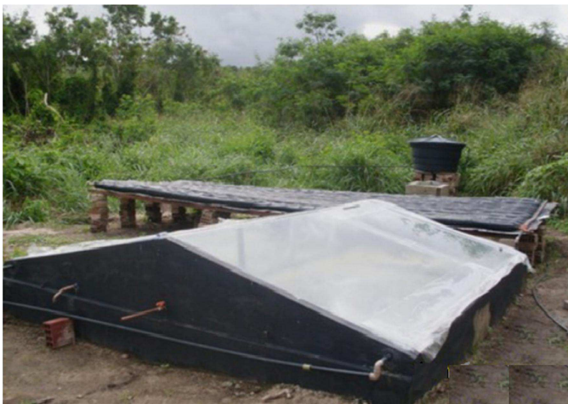
Figura 4 - Dessalinizador solar acoplado a um coletor solar de pré-aquecimento da água Fonte: Marinho et al. , 2012
