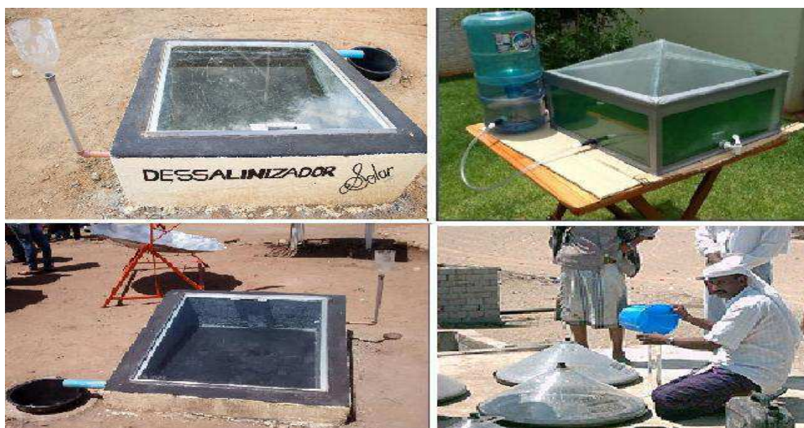
Figura 3 - Dessalinização e desinfecção de águas através de dessalinizadores solar
