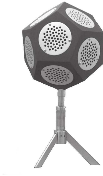
Figura 36 – Dodecaedro: fonte sonora omnidirecional composta por 12 alto falantes (KUTRUFF, 2009).
