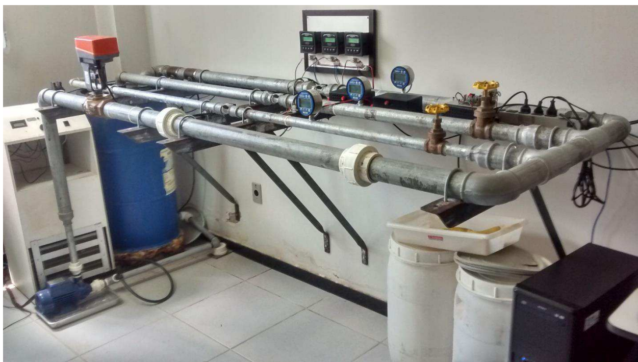
Figura 7-2: Fotografia da Plataforma de Detecção de Incrustação.
