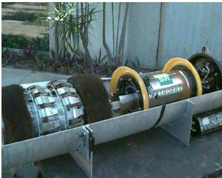
Figura 2-3: Fotografia de um PIG instrumentado cedido pela Petrobrás (SILVA,2008).
