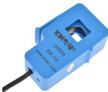
Figura 3-4: Fotografia do sensor de Corrente SCT013-020 (YHDC,2014).
