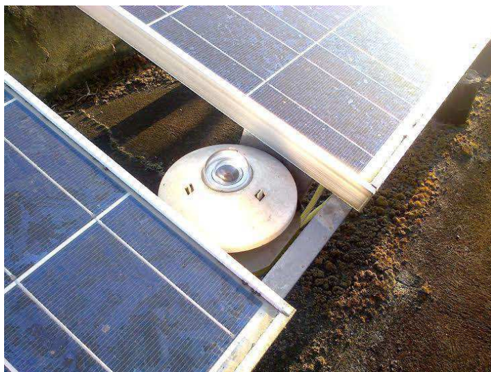
Figura 24: Piranômetro CM21, Kipp & Zonen, instalado no LEIAM
