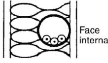
Face interna | Condutores isolados ou cabos unipolares em eletroduto de seção circular embutido em parede termicamente isolante <sup>2)</sup>                            | A1                                 |
