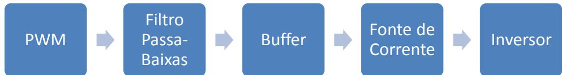
FIGURA 2 - DIAGRAMA DO CIRCUITO DE CARACTERIZAÇÃO
