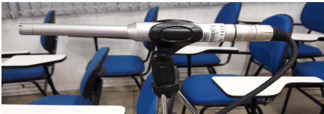
Figura 23 - Microfone inserido no tripé e conectado à interface de áudio durante medições
