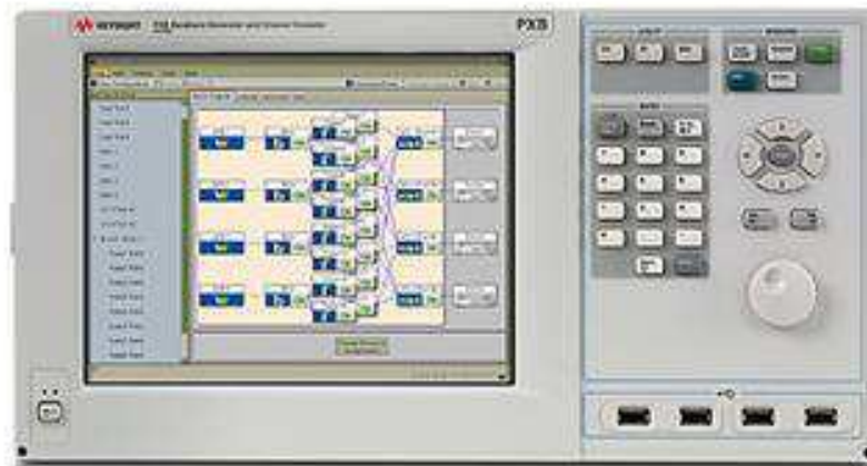
Figura 7: Emulador de canal PXB da Keysight, (fonte: Keysight).
