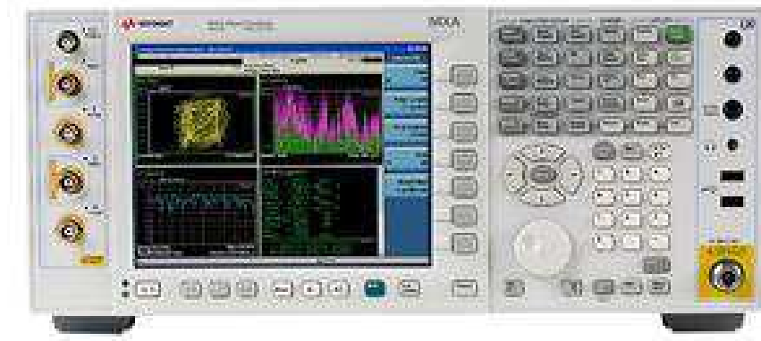
Figura 9: Analisador de modulação MXA. (fonte: Keysight).
