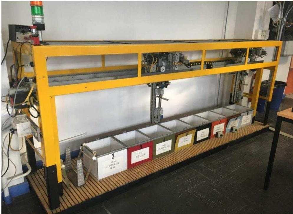
Dessa forma, na plataforma do experimento tratamento de superfícies, um motor é fixado no canto esquerdo da estrutura maior (amarela) permitindo o movimento horizontal de um suporte, com o auxílio de um sistema de polias. Esse suporte se move acima dos recipientes que contém as soluções químicas, e nele estão afixados sensores que asseguram o posicionamento de um sistema motorizado para subir e descer um depósito, no qual estão dispostas as peças a serem tratadas.
