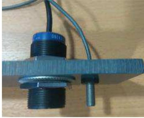
A Figura 3.4 ilustra o funcionamento horizontal da plataforma, os sensores estão fixados no suporte que desliza sobre a esteira e no caminho, acima das posições planejadas, estão os parafusos, a fim de indicar a posição atual.
