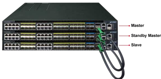
Figura 11 – Empilhamento entre Switches .
