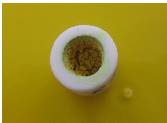
Figura 43 – Amostras de pó dentro do cadinho de alumina.
