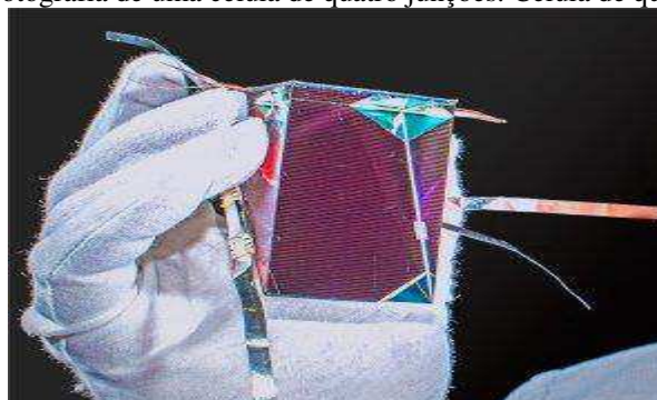
Figura 4: Fotografia de uma célula de quatro junções. Célula de quatro junções
