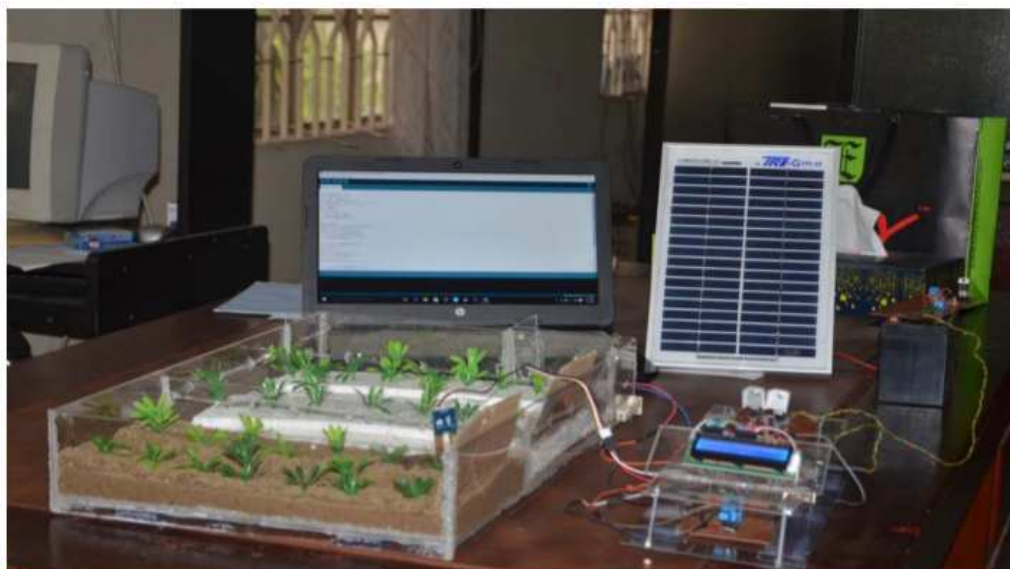
Figura 3.2 – Protótipo de um sistema de irrigação.
