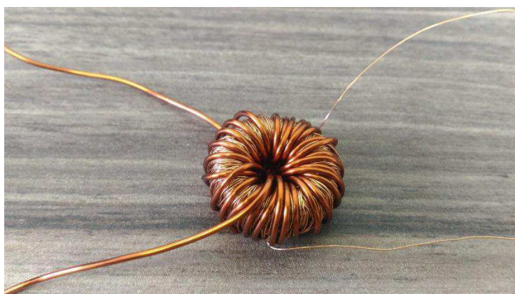
Figura 30 - Transformador de alta frequência
