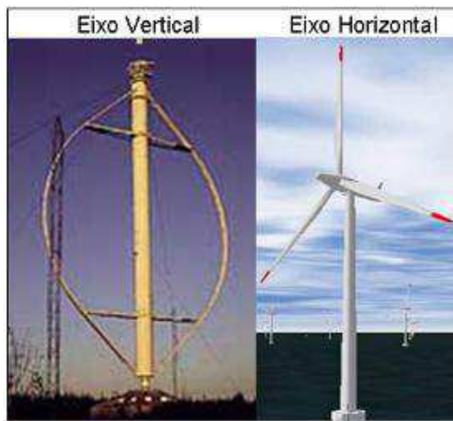
Figura 8 – Turbina eólica de eixo vertical e turbina eólica de eixo horizontal.
