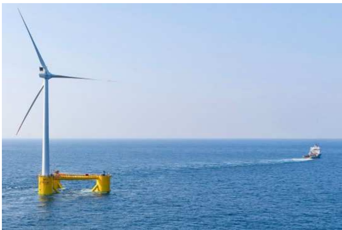
Figura 9 – O primeiro protótipo completo da WindFloat.
