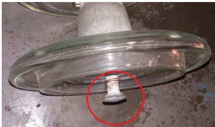
Figura 12– Fio de 10 mm na ferragem do isolador para intensificação de corona.
