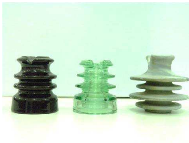
Figura 3 – Isoladores poliméricos, de vidro e de porcelana (da esquerda para a direita).
