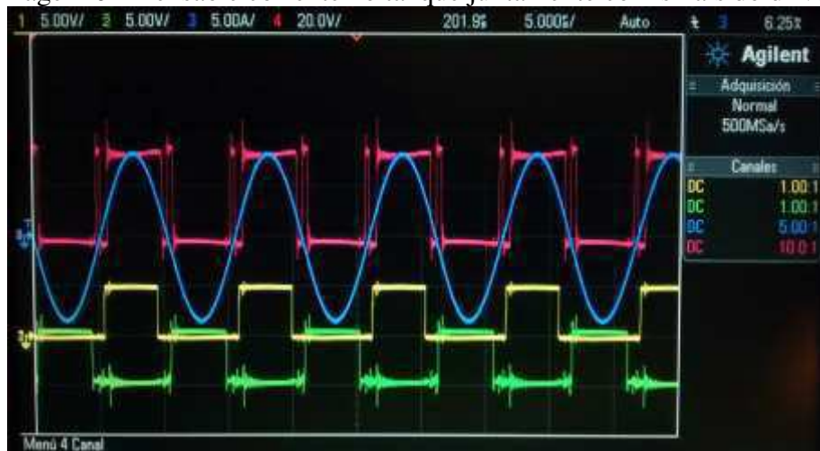
Imagem 6 – Tensão e corrente no tanque juntamente com sinais do driver.
