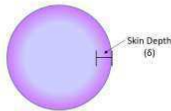
Figura 14 – Ilustração do efeito pelicular.
