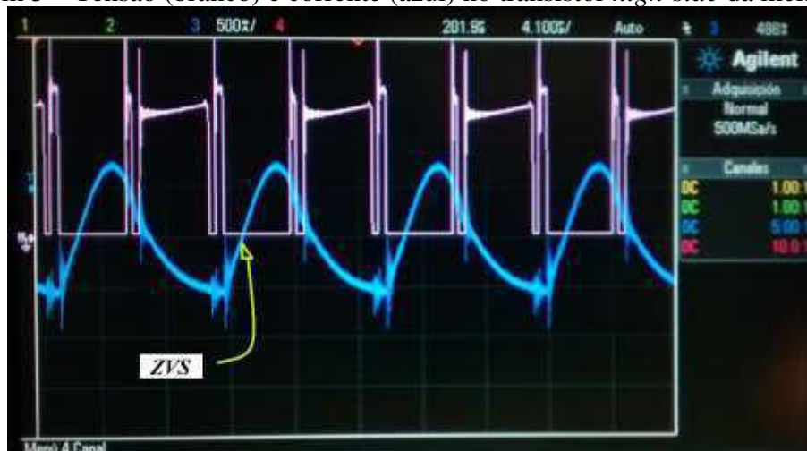
Imagem 5 – Tensão (branco) e corrente (azul) no transistor high-side da meia ponte.
