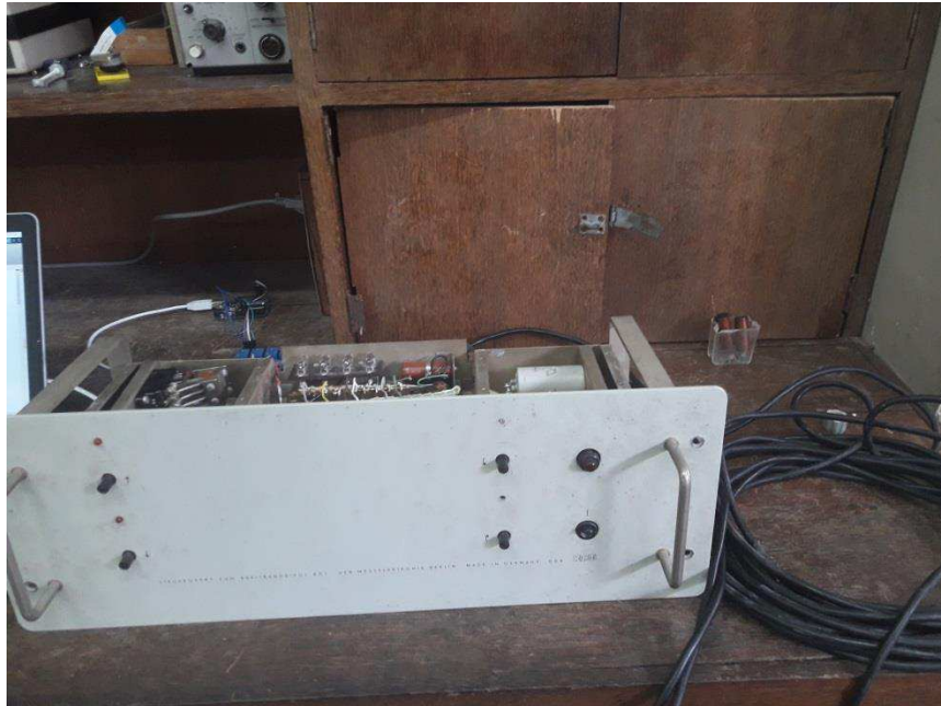
FIGURA 18: CIRCUITO DE COMANDO PARA ACIONAMENTO DOS MOTORES.
