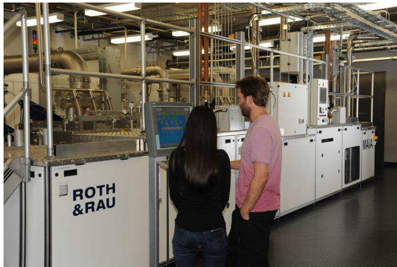
Figura 2.17 – Ferramenta Inline PECVD usada na UNSW
