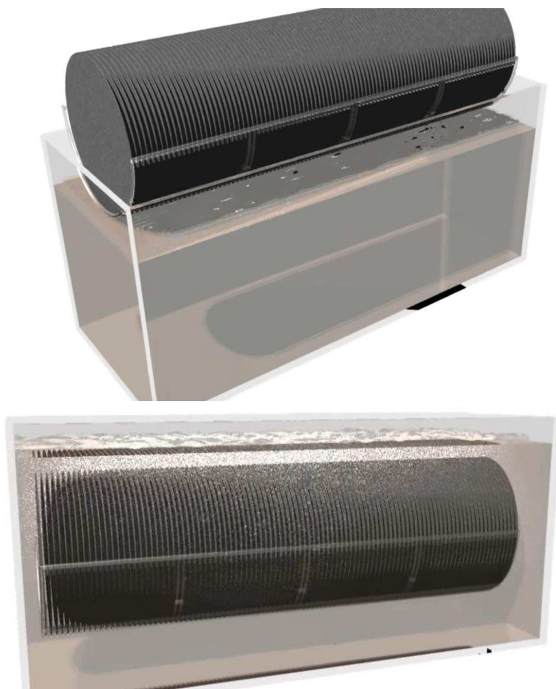
Figura 4.6 – Imagens ilustrativas do banho químico para remoção das superfícies defeituosas
