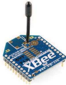
Figura 26 – Fotografia do módulo de comunicação Xbee-pro baseado na tecnologia ZigBee.
