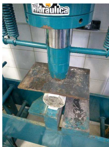
Figura 17: Prensa hidráulica utilizada no ensaio de resistência à tração por compressão diametral.
