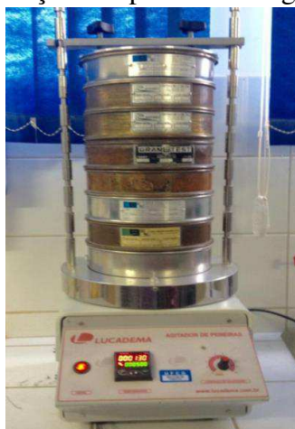
Figura 10: Disposição das peneiras no agitador mecânico.
