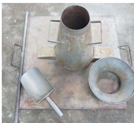
Figura 13: Slup test usado para o ensaio de consistência.
