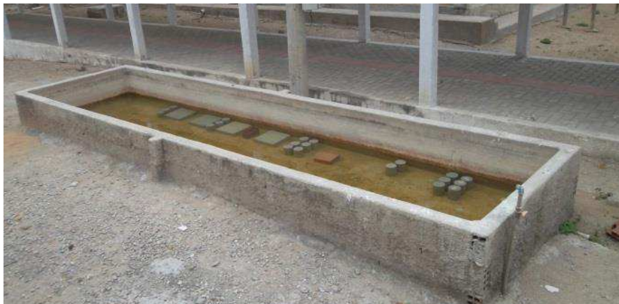
Figura 15: Tanque utilizado para cura dos copos de prova.
