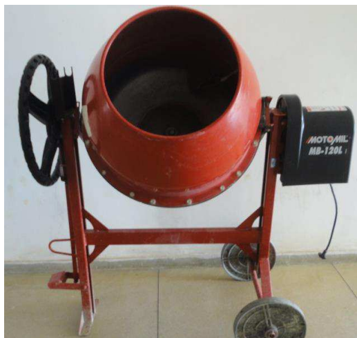
Figura 12: Betoneira utilizada na moldagem.
