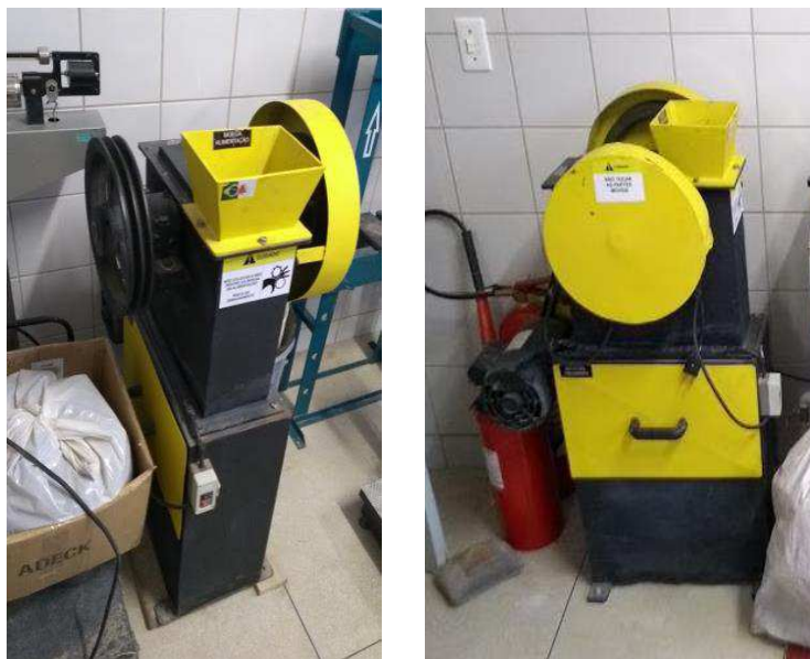
Figura 6: Britador de mandíbula elétrico usado para triturar o material bruto.
