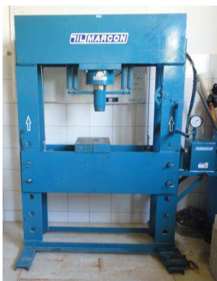
Figura 16: Prensa hidráulica utilizada no ensaio de resistência à compressão axial.
