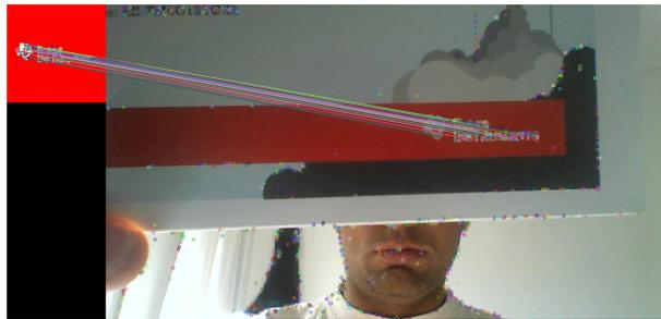
Figura 14 – Feature match utilizando a técnica SIFT
