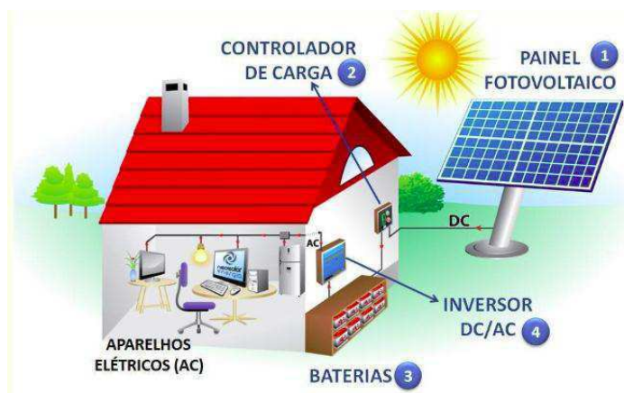
Figura 6 – Componentes de um sistema fotovoltaico.
