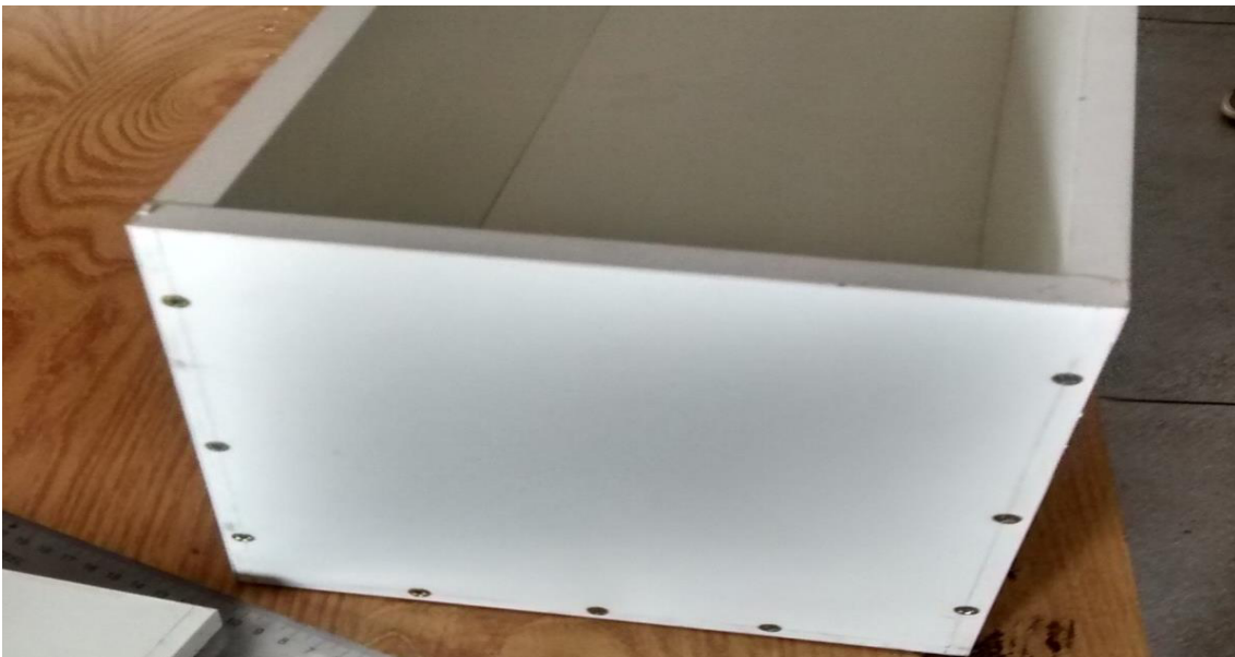
Figura 6: Fixação das laterais menores do módulo
