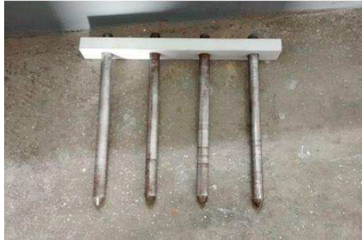
Figura 17: Fixação das hastes à plataforma de alumínio
