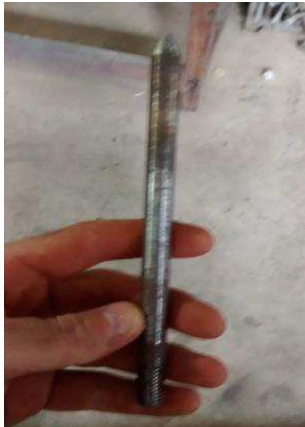
Figura 16: Arredondamento das pontas das hastes de ferro
