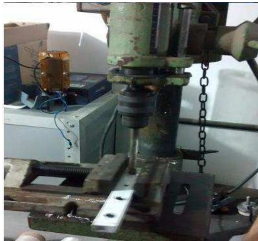
Figura 12: Perfurações de plataformas de alumínio para fixação dos eletrodos
