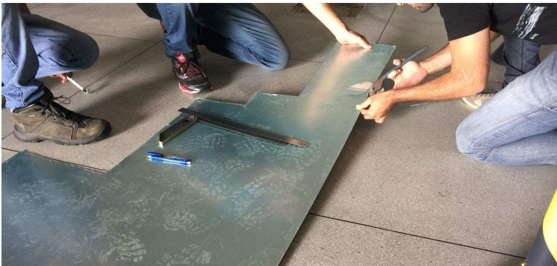
Figura 8: Chapa de alumínio para inserir a corrente elétrica no solo
