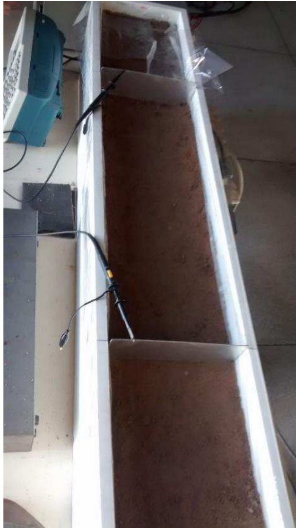
Figura 22: Eletrodos em placas de alumínio – quarto experimento
