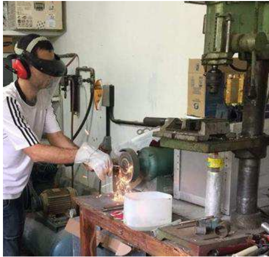
Figura 15: Redução das hastes de ferro
