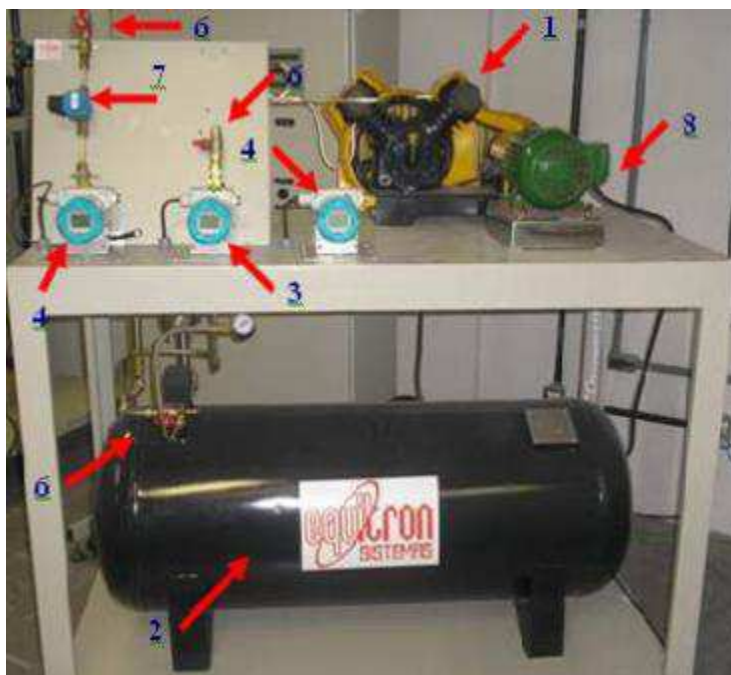
Figura 15: Bancada de Compressor
