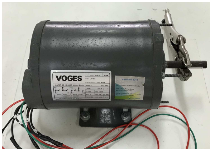
Figura 13 – Motor de indução VOGES 110/220V de fase dividida.
