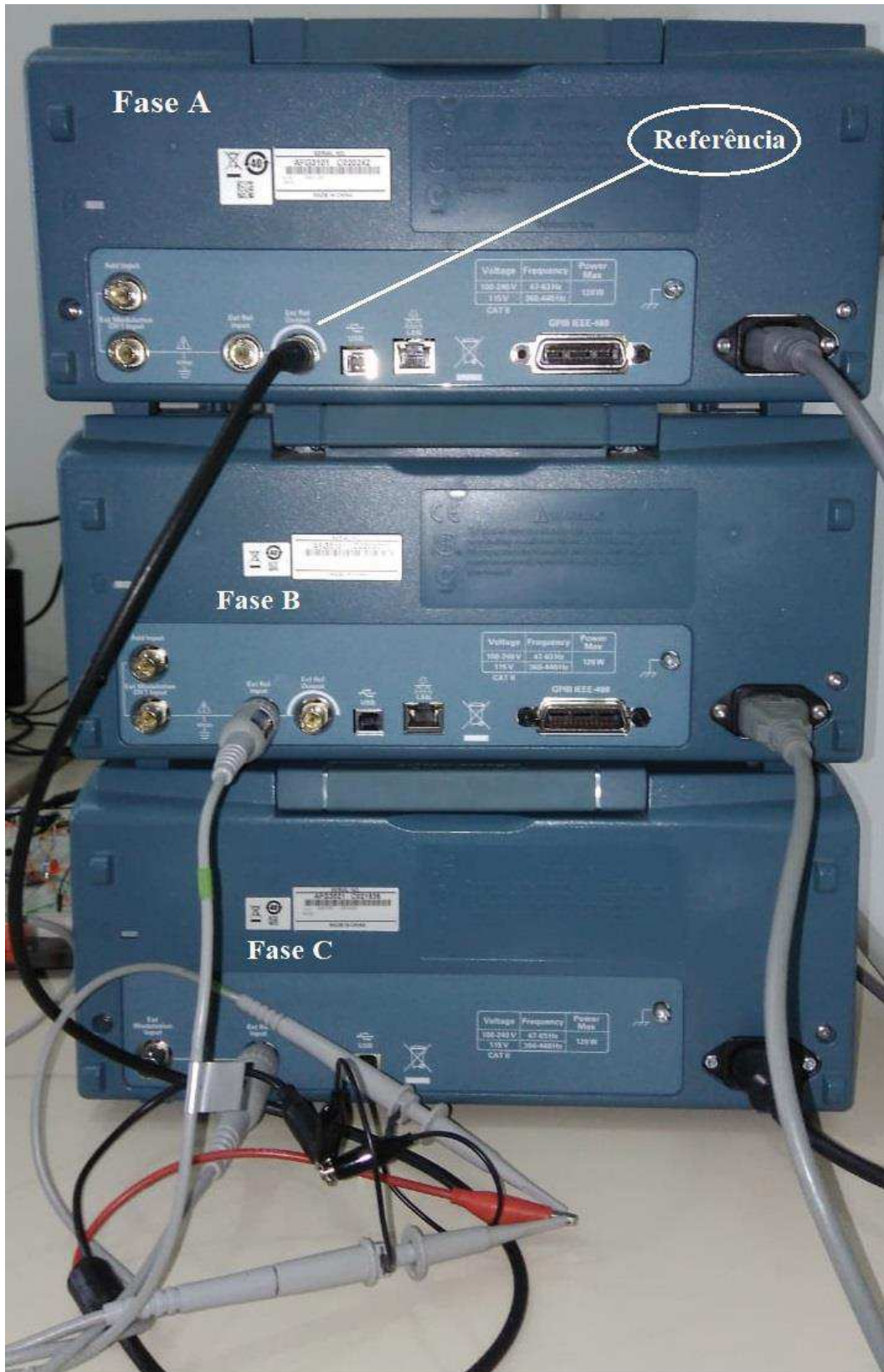
Figura 10 - Geradores de função interligados no mesmo referencial.
