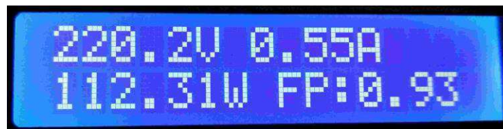
Figura 40 - Fotografia do Display com carga mista após a correção do fator de potência.
