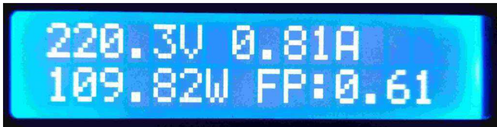
Figura 37 - Fotografia do display com carga mista antes da correção do fator de potência.
